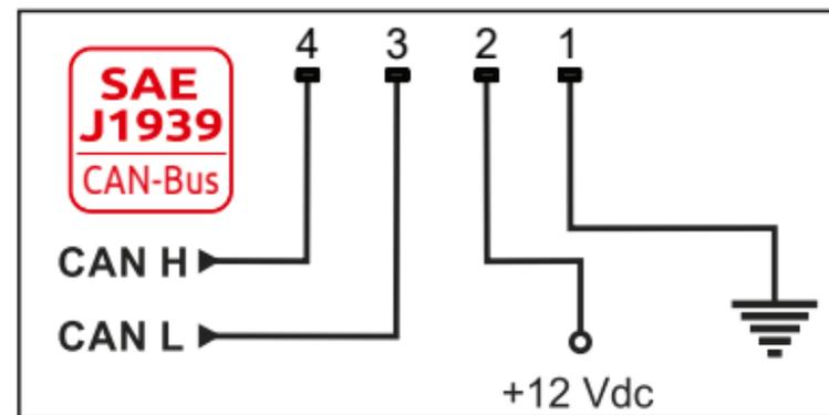
Le valvole a sfera serie 853 con collegamento CAN-Bus sono dotate di un apposito connettore Tyco Superseal® a 4 poli con innesto a pressione. All'interno l'elettronica è in grado di gestire la rotazione della sfera a passi di 1°. Il sensore rileva la posizione della sfera e fornisce al dispositivo (collegato tramite la porta di comunicazione CAN-Bus) precise indicazioni sul movimento della stessa, in tempo reale.
